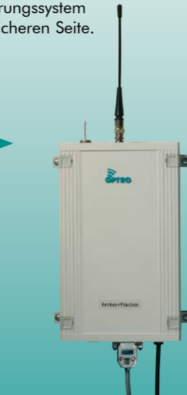
Funk-Sende-Modul Eingangsmeldung der GMZ und Weiterleitung per Funk an den Alarm-Pager
