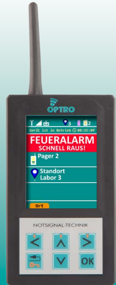
Alarm-Pager empfängt Warnmeldung vom Interface – Signalisierung durch Akustik und Vibration – sowie Klartext-Info auf dem Display
